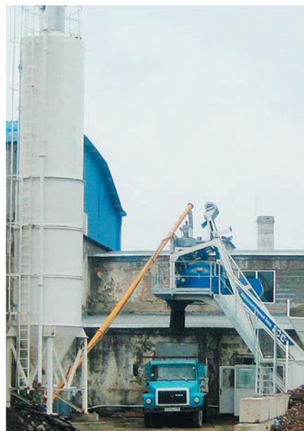
уже включена в штатную комплектацию БСУ; наличие планетарного бетоносмесителя объемом 500/350 литров позволяет осуществлять выпуск любых разновидностей смесей, в том числе и жестких для линий вибропрессования; монтаж-демонтаж установки не превышает 3-4 дней. По этим и ряду других критериев модель МЕКАМІХ-20 не имеет аналогов на рынке.
