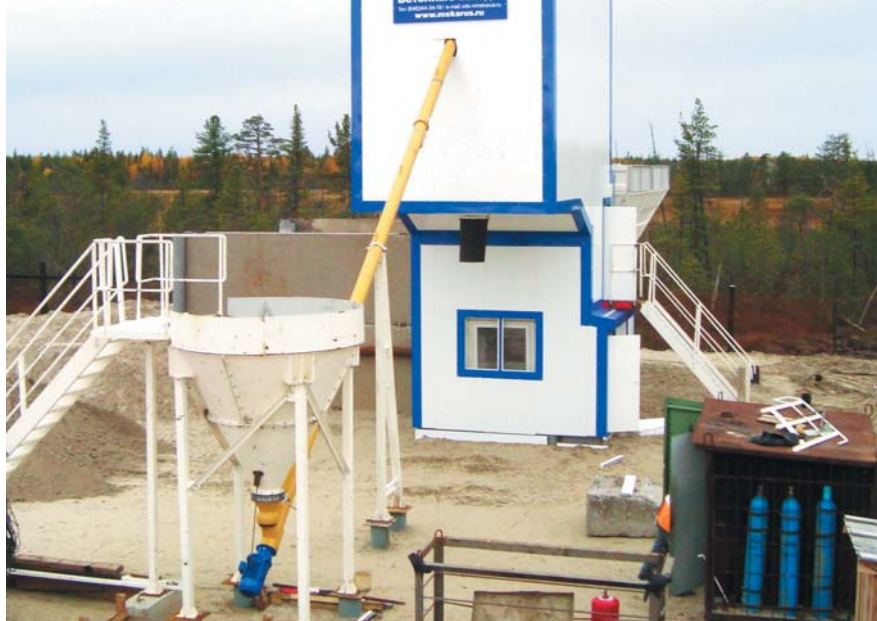
Пунгинское ПХГ, Бетонный завод МЕКАМIX-30 СОМРАСТ. Завод оснащен устройством выгрузки и подачи цемента из мешков. Другого способа доставки цемента на объект не существует
