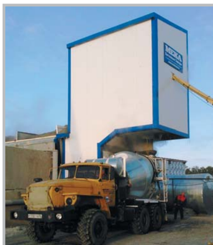
Пунгинское ПХГ, Бетонный завод МЕКАМIX-30 СОМРАСТ. Завод оснащен устройством выгрузки и подачи цемента из мешков. Другого способа доставки цемента на объект не существует
